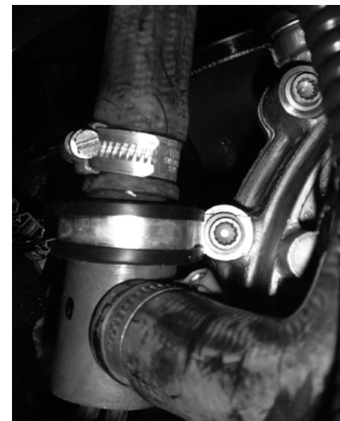
1.2 TSI med manuell växellåda, använd gummiklamma i befintlig skruv på växellåda.
