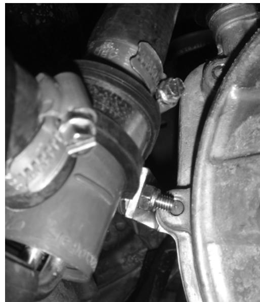
1.4 TSI med manuell växellåda, använd gummiklamma och fäste i befintlig skruv på växellåda.
