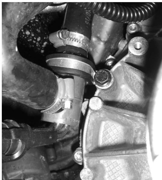
1.4 TSI med DSG, använd gummiklamma och medlevererad M8 skruv.
